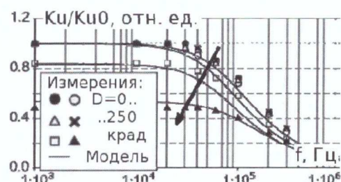
Рис. 3 АЧХ КНИ КМОП ОУ: расчёт (линии), эксперимент (значки) в диапазоне дозы до 250 крад
