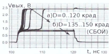
Рис. 1 Характеристики блока записи 0,5 мкм КНИ КМОП 512 кбит ОЗУ в диапазоне дозы до 150 крад: нет сбоя (а), сбой (б)
