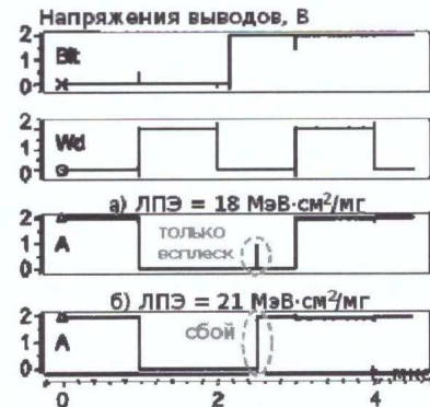
Рис. 5 Моделирование сбоя при попадании ОЯЧ в 6Т ячейке памяти: нет сбоя (а), сбой (б)
